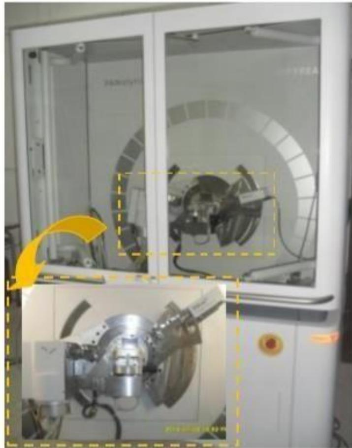
Figure II.5: Diffractomètre de marque EMPYREAN.
