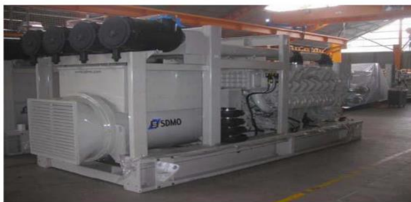
Figure II-11 : Groupe Electrogène de secours [5].
