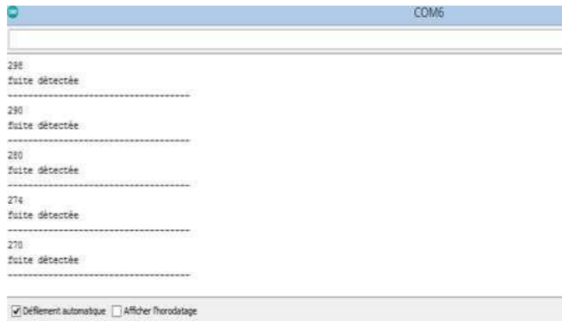
Figure 20 : fuite de gaz affiché via moniteur série
