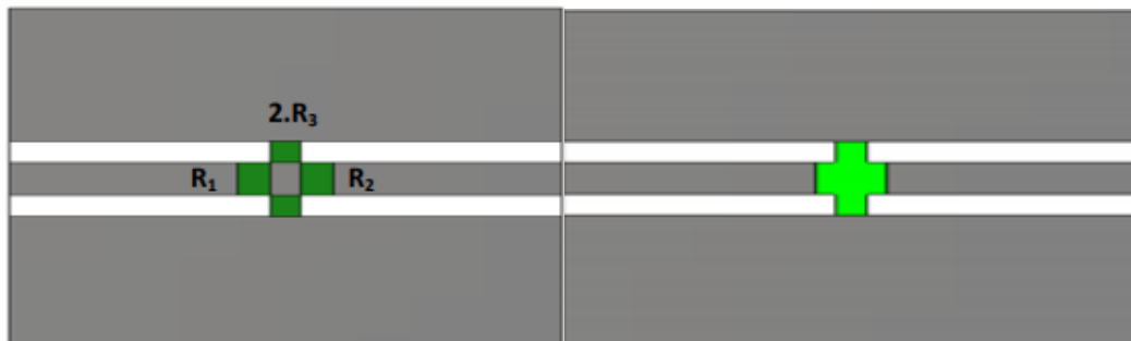
Figure II.20 : Atténuateur coplanaire en T : prototype 1 (à gauche) et prototype 2 (à droite) [65]
