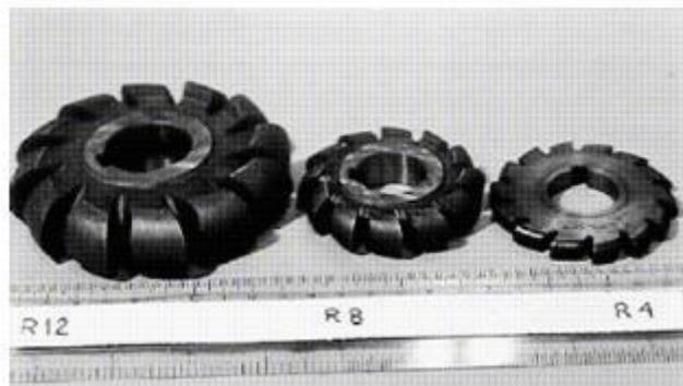
**Figure II- 5 : Disques coupants utilisés**
