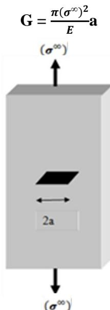
Figure I- 5 : Fissure traversant de longueur  $2a$  dans une plaque infinie
