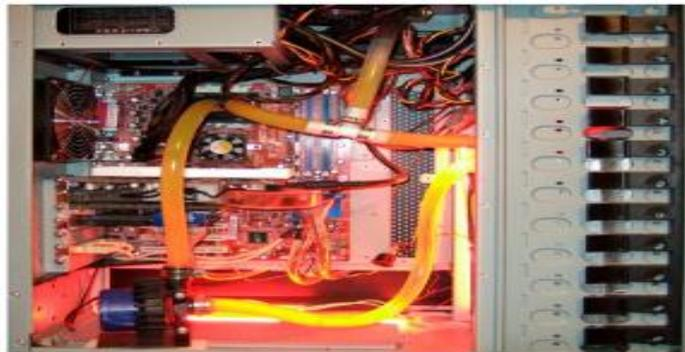
**Figure I.12** : Exemple d'un refroidissement régulier à liquide configuré pour un ordinateur.
