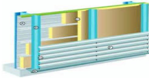
**Figure I.8:** Bardage à double peau.
