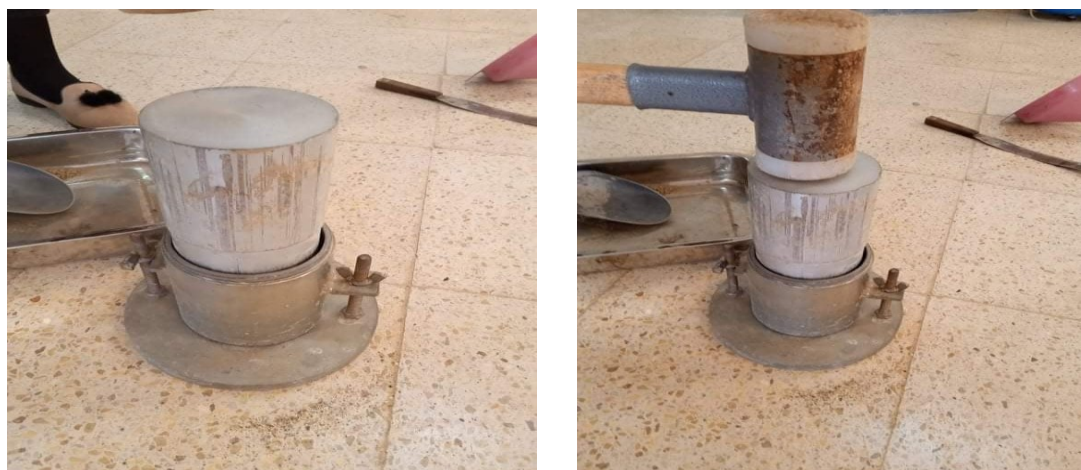
Figure II. 6: Procédure d'essai pour calculer e_{min}
