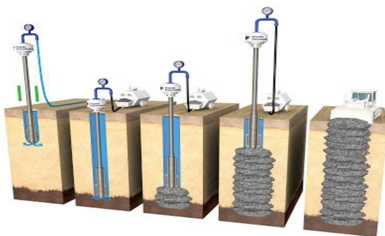
Figure I. 13: Principe d'injection de colonnes ballastées
