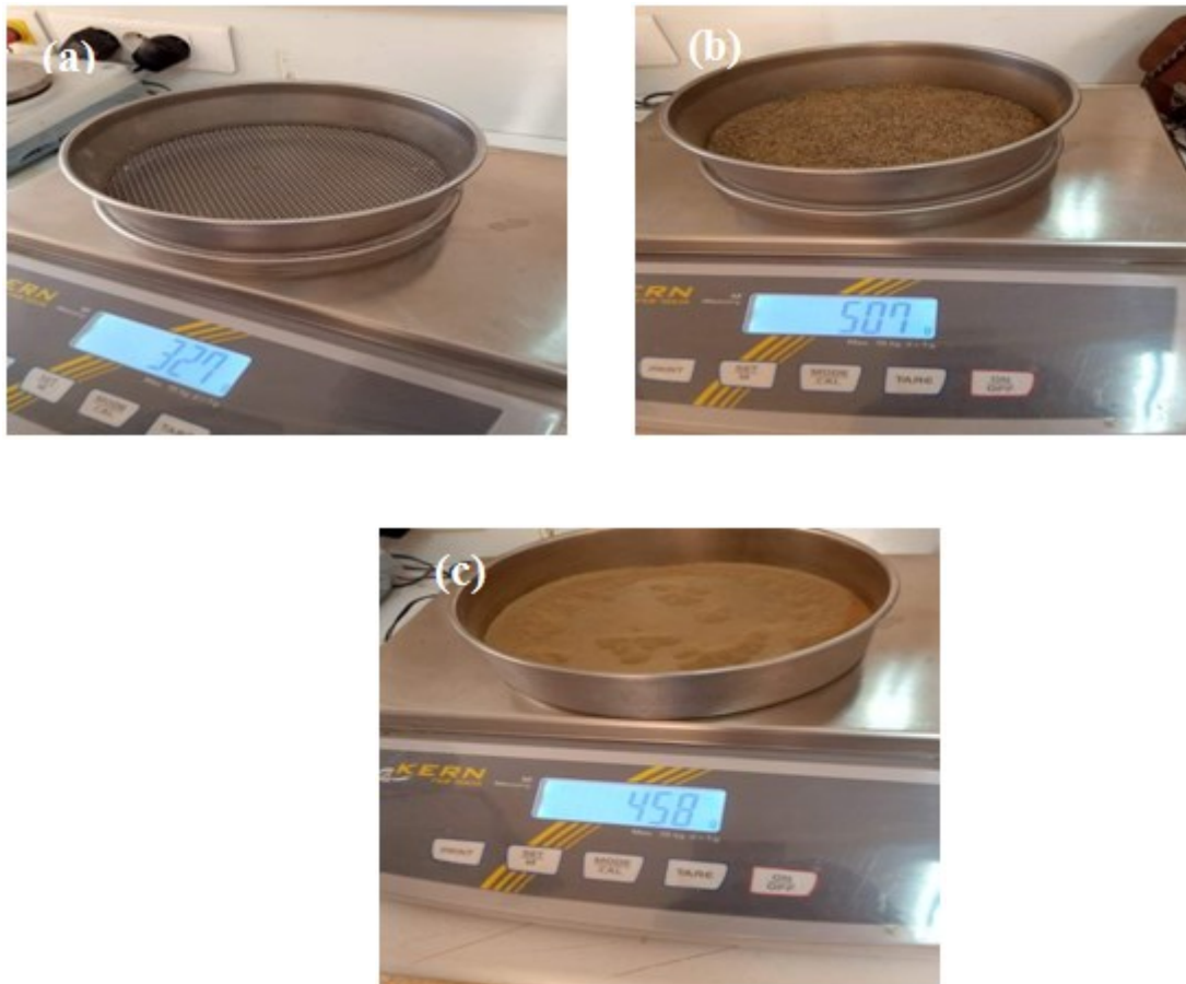
Figure II. 2: Essais d'analyse granulométrique par tamisage, a) Tamis vide +balance, b) tamis + sable de Chlef+balance, c) Tamis + limon +balance
