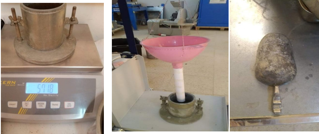
Figure II. 5: Procédure d'essai pour calculer e_{max}
