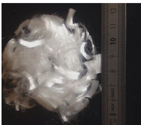
Figure II. 7: Fibre de polypropylène utilisée dans les essais
