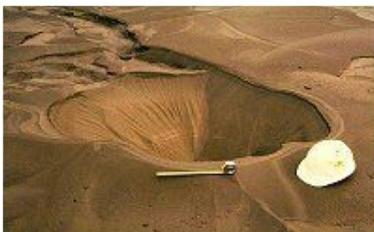
Figure I. 2: Affaissement d'un sol granulaire à Loma Prieta (USA) en 1989
