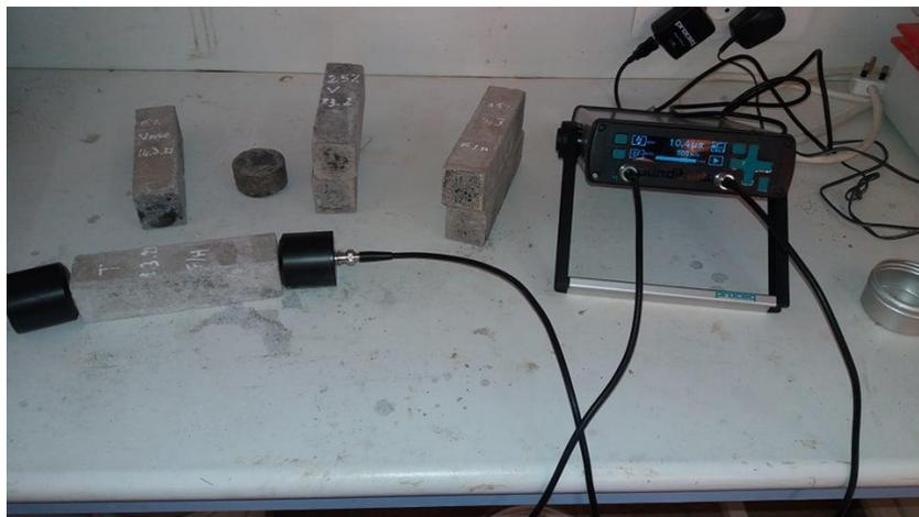
**Fig. II-8.** Essai ultrasonique.
