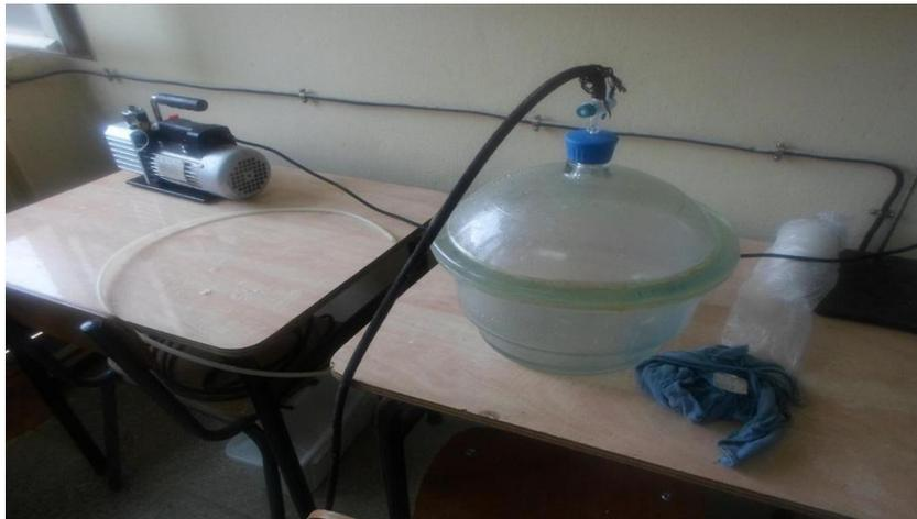
Fig. II-16. Essai de la porosité accessible a l'eau.
