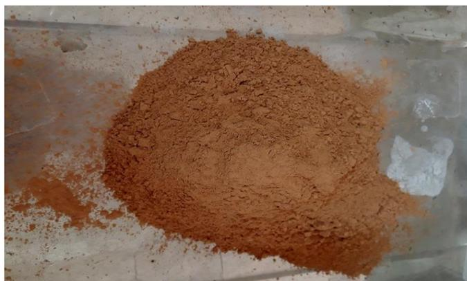
Fig. II-9. Le produit final de la vase calcinée de Barrage de SEKKAK.
