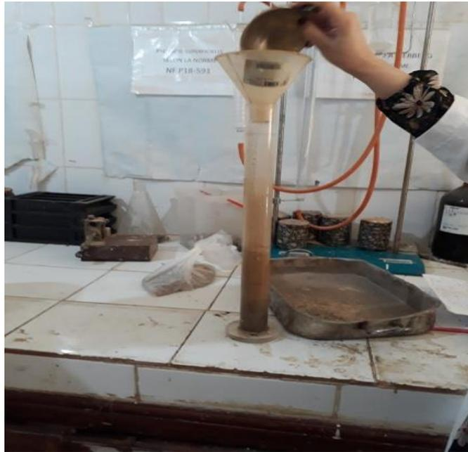
**Fig. II-8.** Essai de l'équivalent de sable [Laboratoire LTPO (Ain-Témouchent)].
