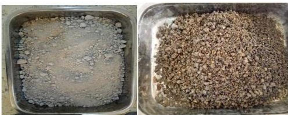
Figure III. 7: Echantillon après passage à l'appareil LOS-Angeles et rinçage.
