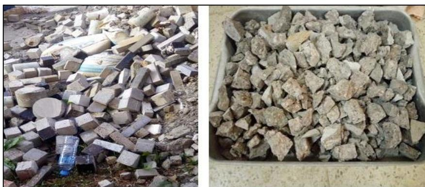
Figure III. 2: Le déchet de démolition avant et après le concassage manuelle
