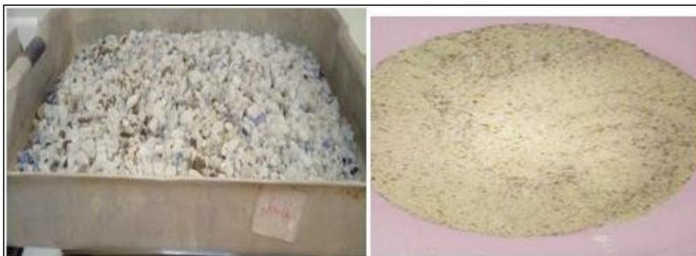
Figure III. 4: Le verre broyé avant et après le concassage
