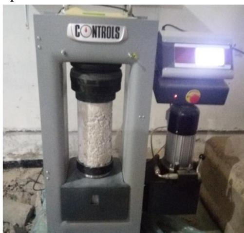
Figure III. 10 Appareil d'écrasement des éprouvettes.
