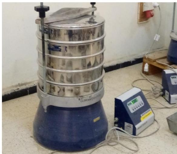
**Figure III. 5: La machine à tamiser**
