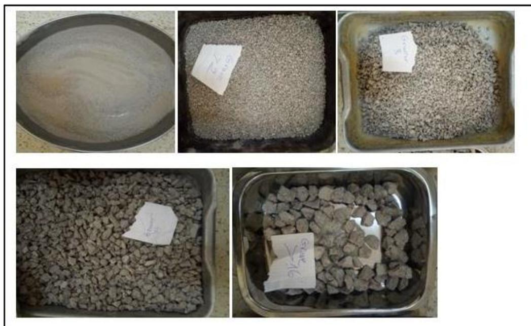
Figure III. 3: Différentes fractions granulaires récupérées
