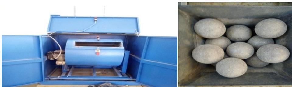
Figure III. 6: Machine Los Angeles et les boules utilisés
