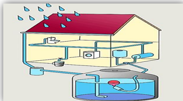
Figure 22: récupération de l'eau de pluie en toiture
