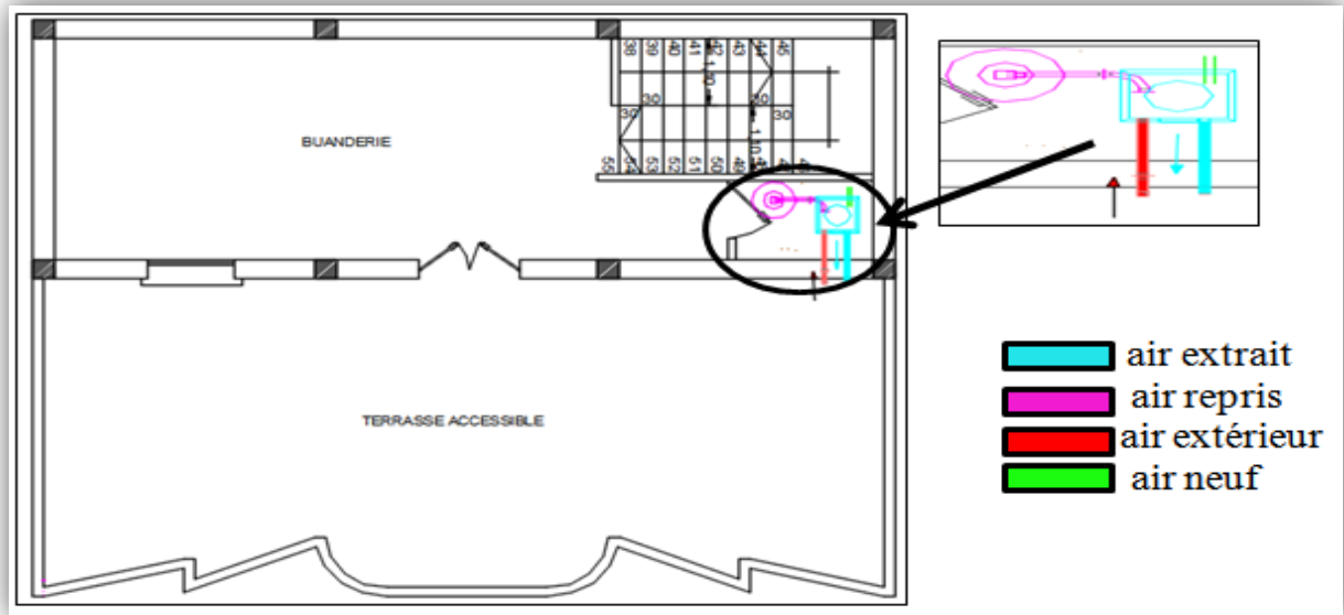
Figure 57 :l'instalation de VMC double flus sur notre bâtiment
