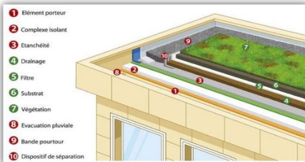
Figure 49:coupe d'une toiture végétalisée
