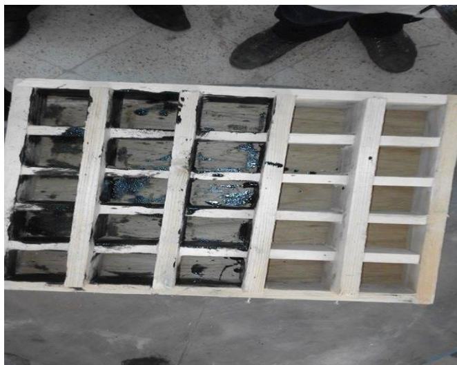
Fig.12- : Moules pour éprouvettes de béton(70×70×70mm)
