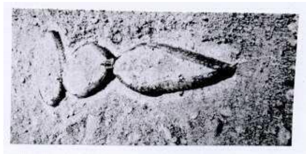
Figure 19: Allure des bandes de roulement sur chant après essai (LONG, 1993)
