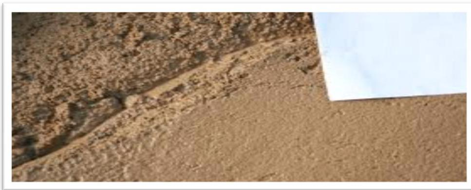
Figure 2.3 : le sable roulé siliceux [2]
