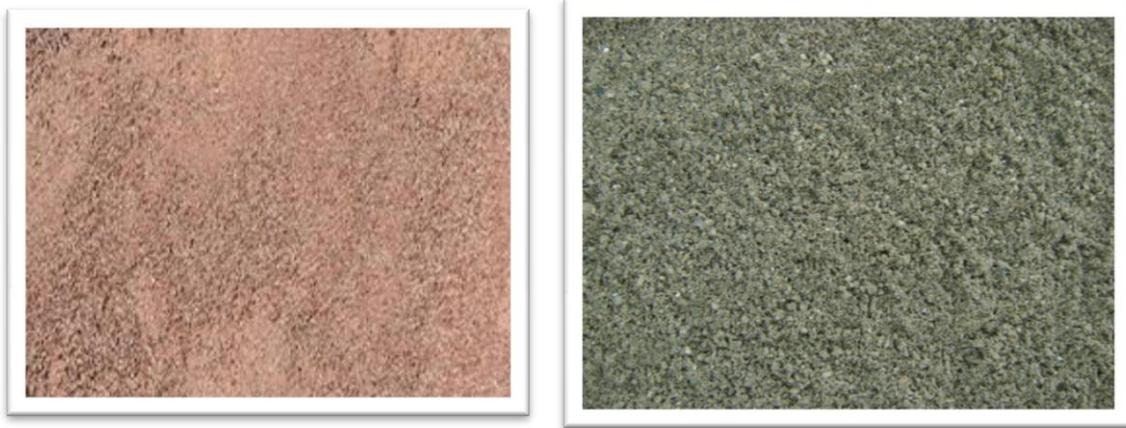
Figure 2.4: les sables de concassages calcaire. [2]
