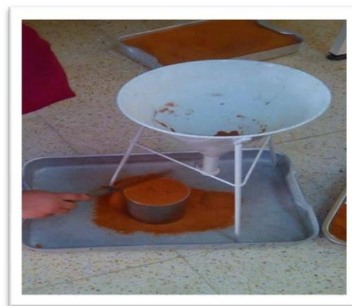
Figure 4 .10: Les matériaux de la masse volumique apparente
