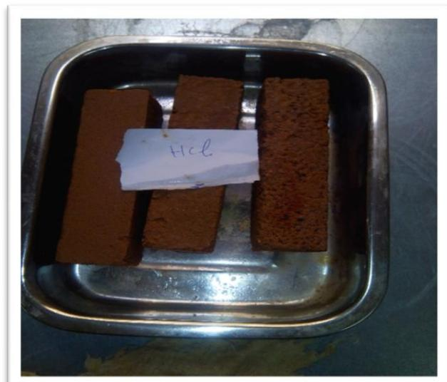
**Figure 5.3:** éprouvette conservées en HCl.
