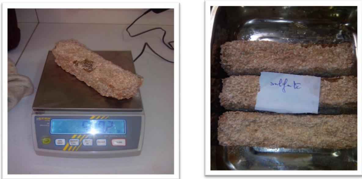
**Figure 5.5:** éprouvette conservées en H<sub>2</sub>SO<sub>4</sub>.
