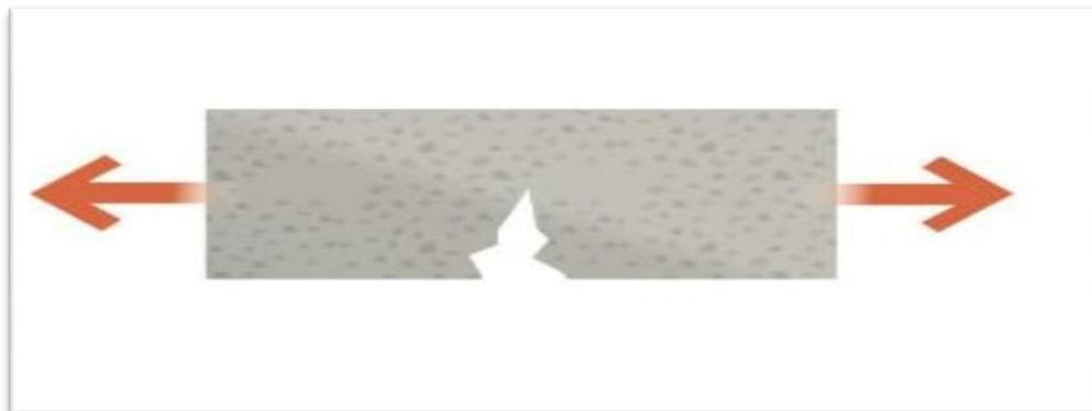
Figure 1.16: effet de traction sur le béton simple [2]
