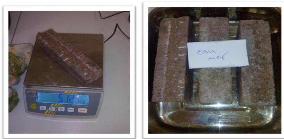
**Figure 5.7:** éprouvette conservées à l'eau de mer.
