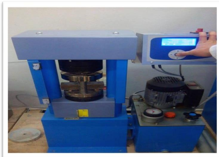
Figure 4.28: écrasement des éprouvettes du mortier
