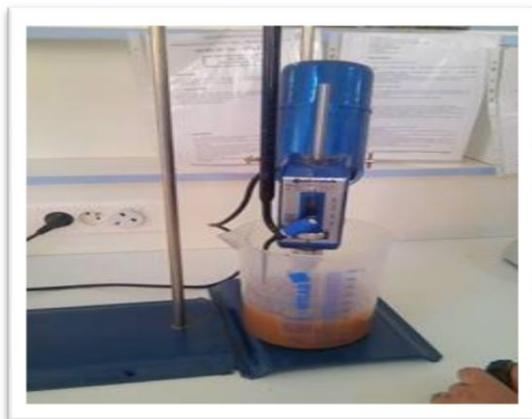
Figure 4 .4 : Analyse de bleu méthylène
