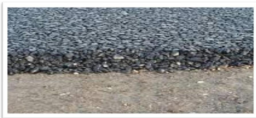
Figure 1.10: Le béton bitumineux [2]
