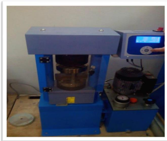
Figure 4.27: Machine de compression et de flexion.
