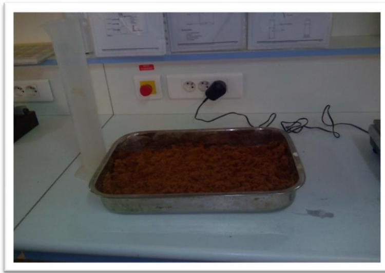
Figure 4.14 : Les matériaux de Foisonnement de sable
