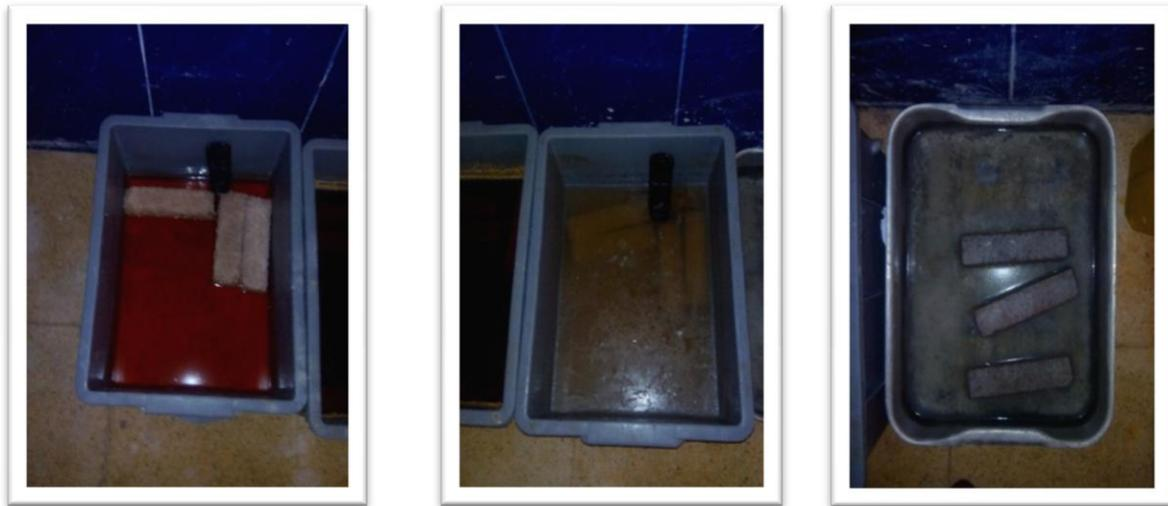
Figure 4. 26: Conservation des éprouvettes dans les solutions chimiques.
