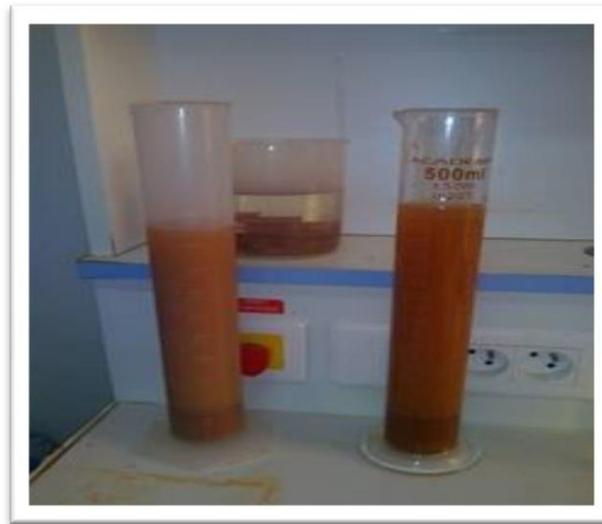
Figure 4 .9: Résultat d'équivalent de sable
