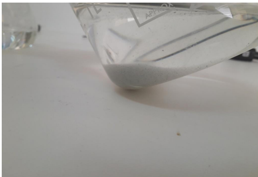
Photo 29 : décantation des sédiments après 1h
