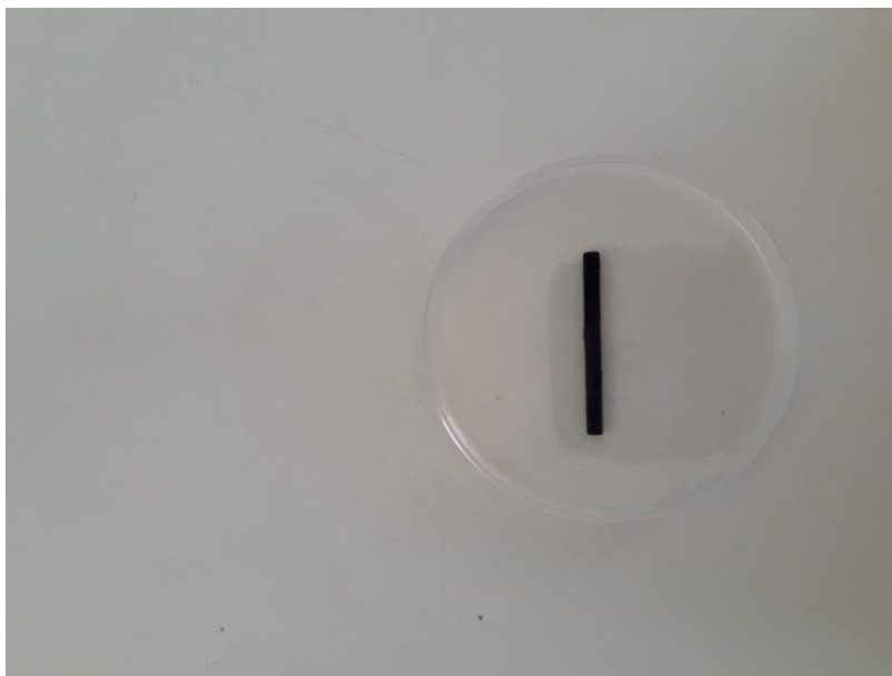
Photo 22 : arbre de pile
