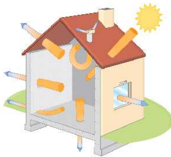
Figure IV.2 : les pertes thermiques
