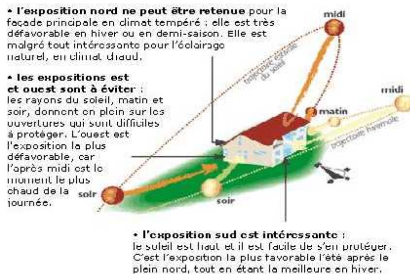
Figure II-3 : orientation d'une maison par rapport au soleil
