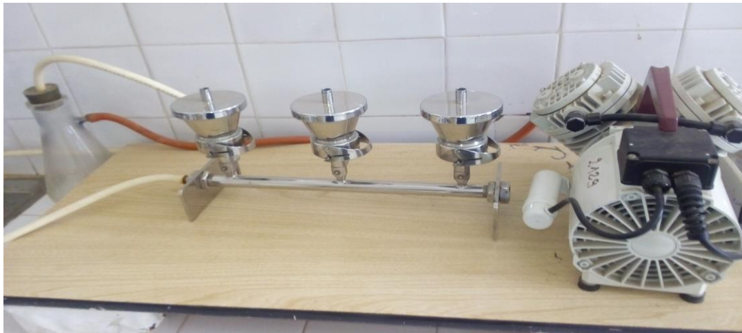
Figure 12 : Appareil de filtration sur membranes
