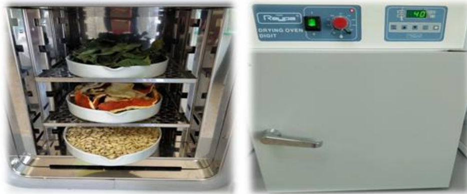
Figure 7 : Séchage des échantillons dans l'étuve à 40°C (Photo originale, 2022).
