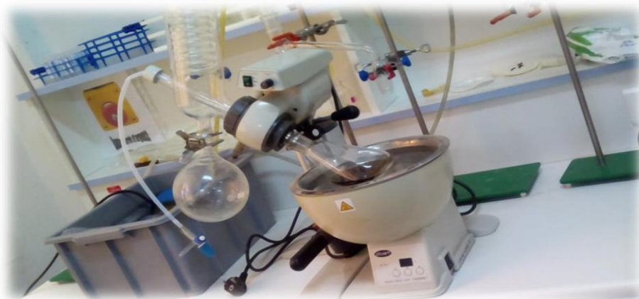
Figure 9 : Evaporateur rotatif sous vide (Photo originale, 2022).
