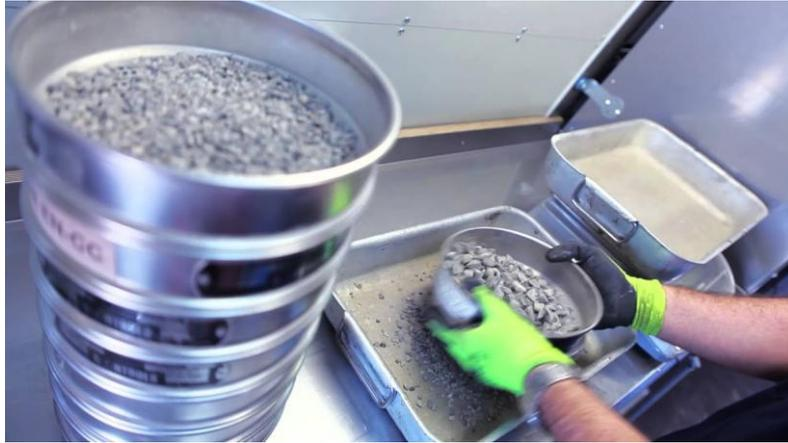
*Figure 11 : analyse granulométrique [26]*
