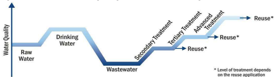
Figure XVI : Qualité de l'eau en fonction des types de traitement appliqués aux eaux usées (tiré de : US EPA, 2012)
