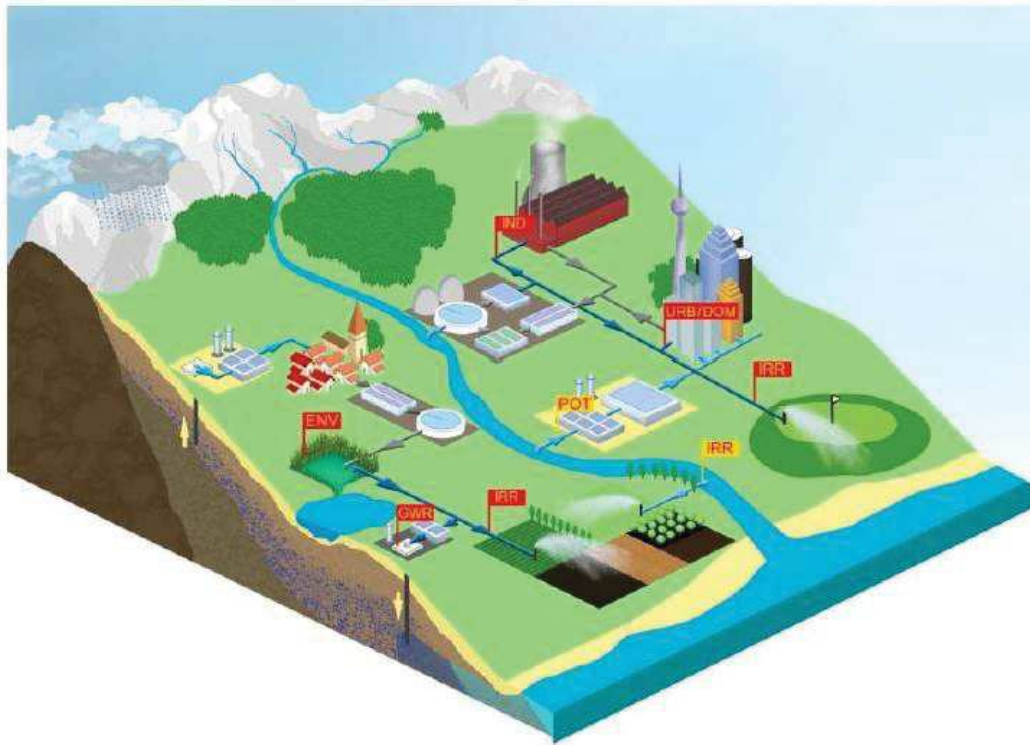
Figure XVII : Schéma représentant la réutilisation directe et indirecte des eaux usées (tiré de : AQUAREC, 2006)
