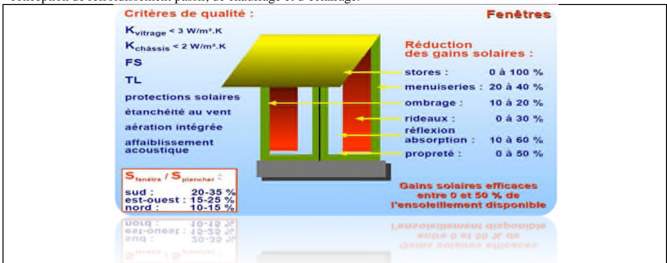
Fig.III. 2 : Choix des composants et identification des facteurs intervenant dans la thermique de la fenêtre. (Source : De Herde & Liébard 2005)
