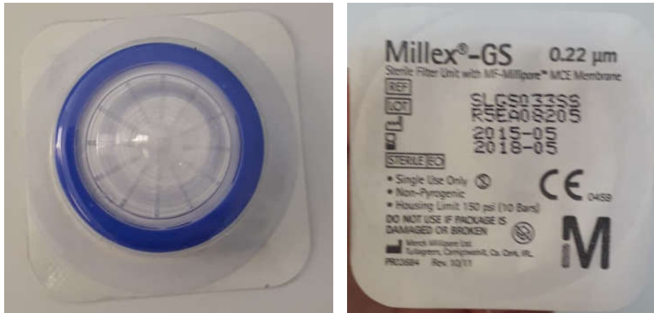
Figure 30: le filtre utilisée dans la filtration de l'eau de mer
