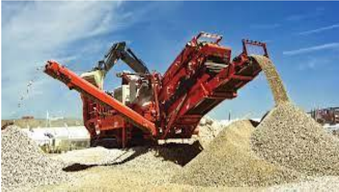
Figure I.8 : Broyeur à fragmentation fine (1000 à 10 \mu m).
