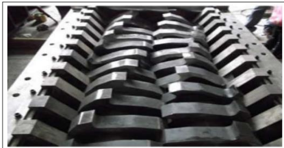
Figure I.16 : Broyage pour carton.
