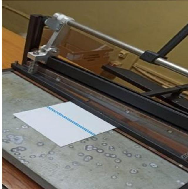
*Figure 4 19: découpage de la plaque présensibilisé.*
