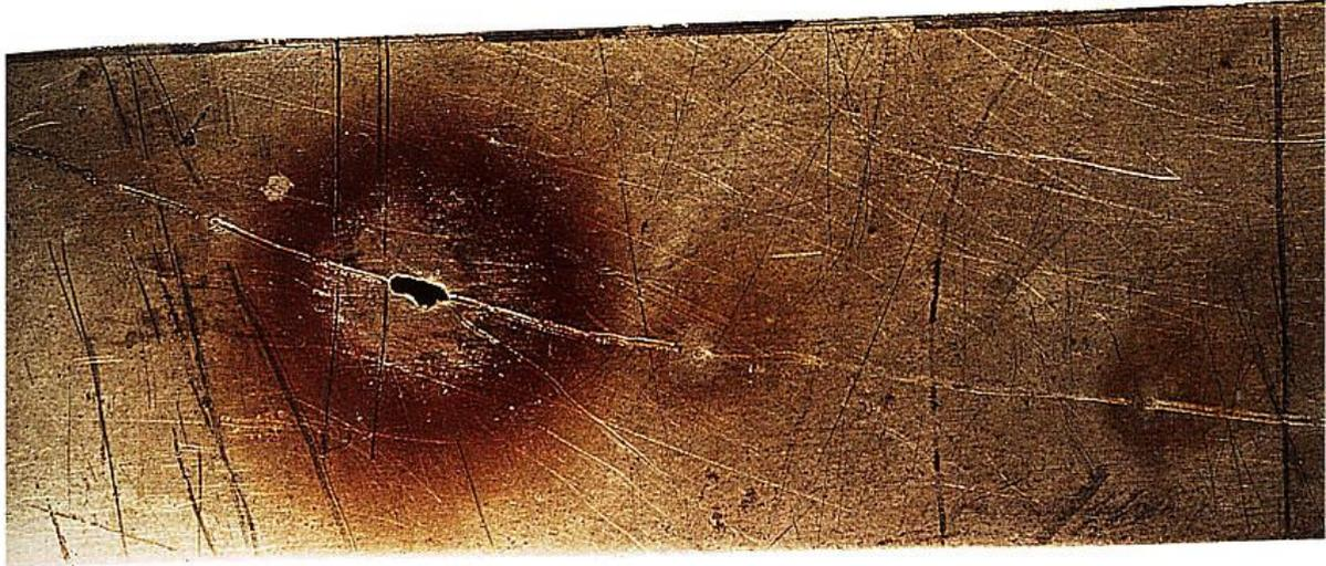
*Figure 1 6: corrosion par piqûres. [4]*
