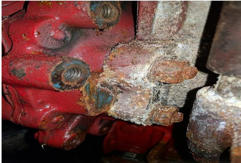
*Figure 1 5: corrosion galvanique.* [4]
