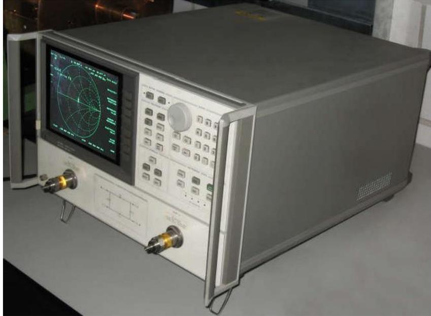
*Figure 4 18: Un analyseur de réseau.*
