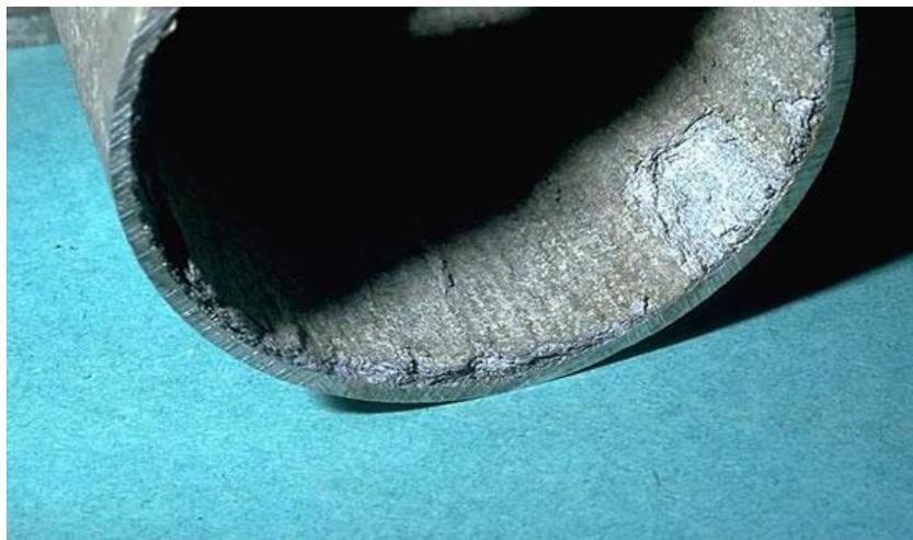
*Figure 1 4: corrosion intergranulaire. [4]*
