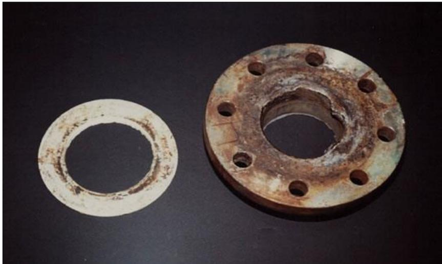
*Figure 1 3: corrosion par crevasse. [4]*
