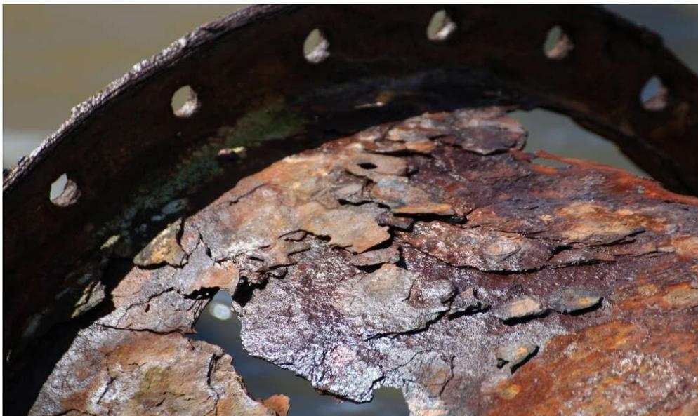
*Figure 1 2: La corrosion du métal. [2]*
