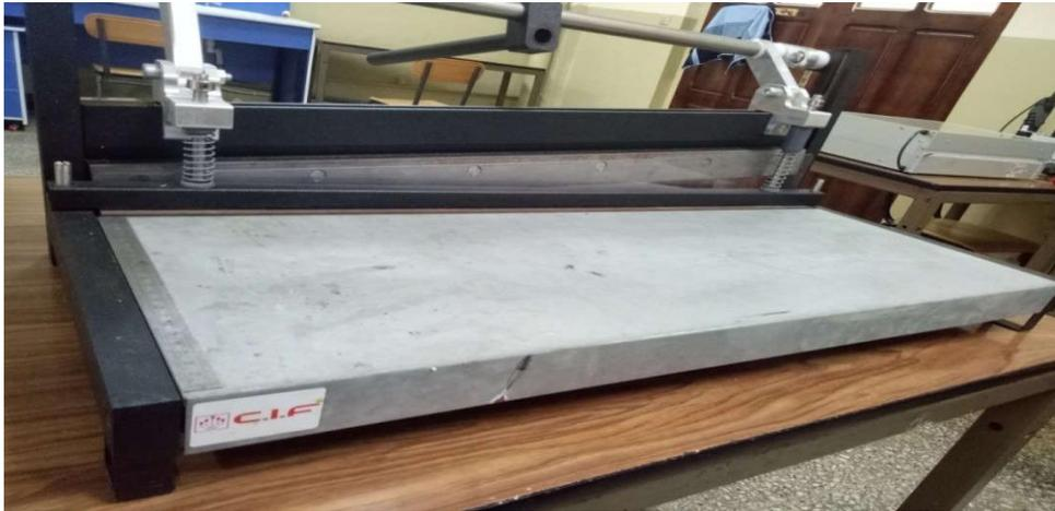
*Figure 4 13: Le découpeur des circuits imprimés.*
