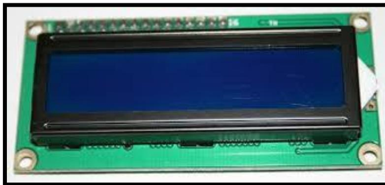
**Figure II. 11** : Afficheur LCD 2x16.
