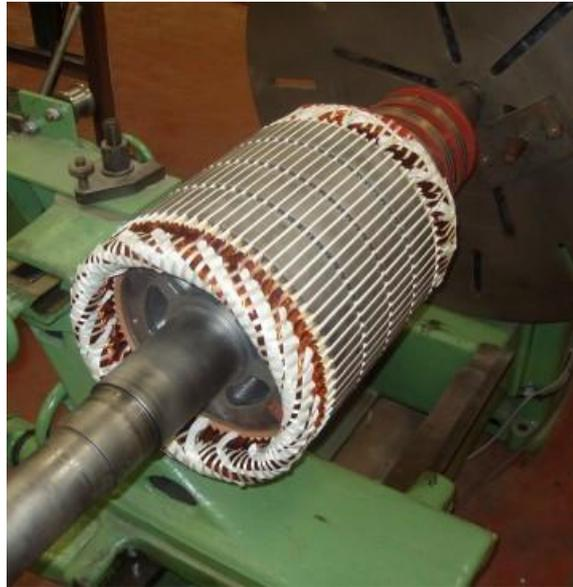
*Figure I-4: le rotor bobiné d'un moteur asynchrone. [8]*
