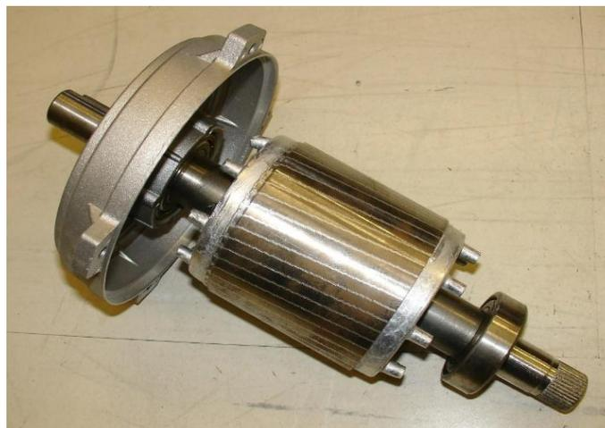
*Figure I-5: le rotor à cage d'un moteur asynchrone. [9]*
