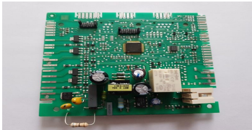
Figure II.5 : Carte électronique du lave-vaisselle [w17].
