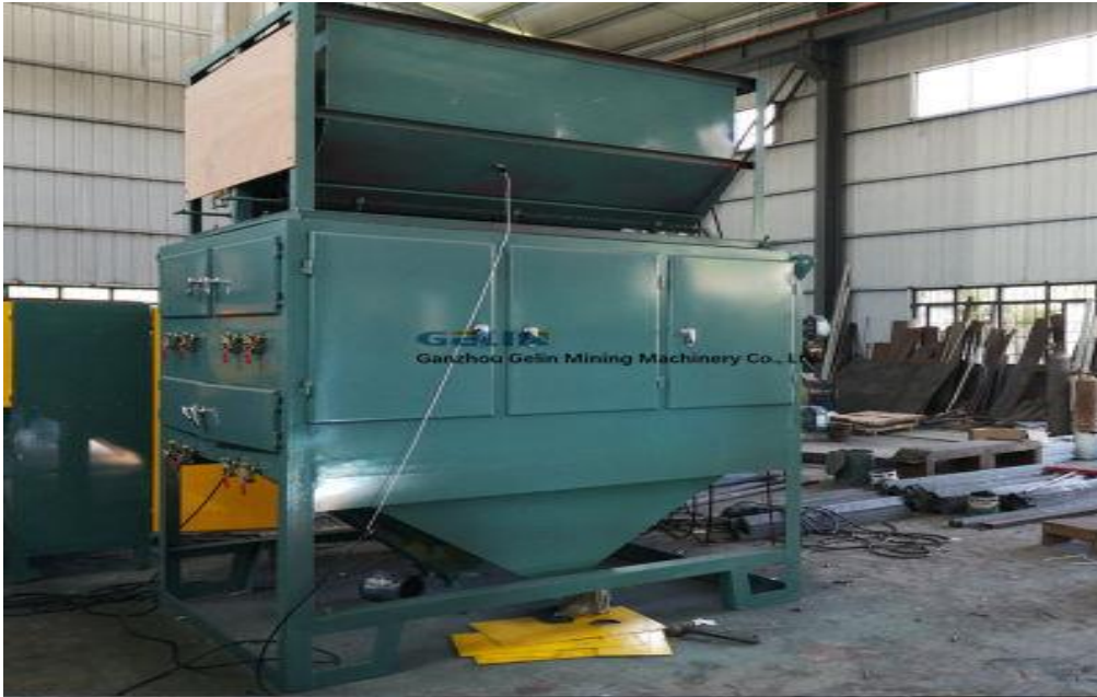
Figure I.9 : Séparateur électrostatique haute tension [20]
