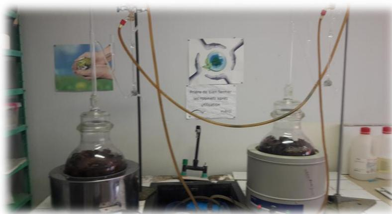
**Figure 11.** Appareil d'extraction des huiles essentielles par hydro distillation« Clevenger ».
