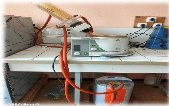
**Figure 13 :** Appareil évaporateur rotatif(Rotavapeur)
