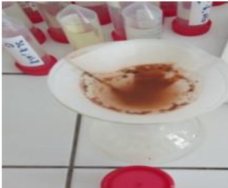
Figure 12 : Filtration des sediments
