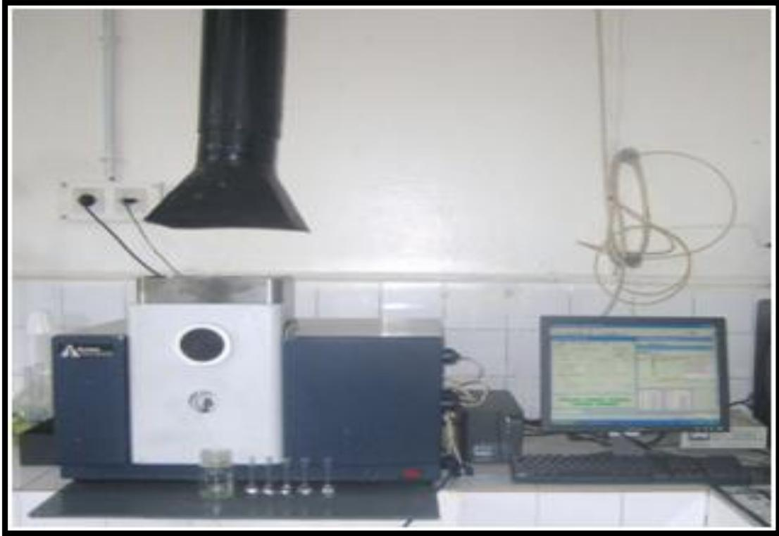
**Figure 15 :** Spectrophotomètre d'absorption atomique à flamme de type AURORA ai.1200
