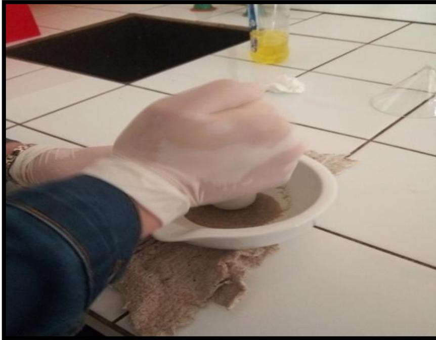
**Figure 7 : Broyage des sédiments**
