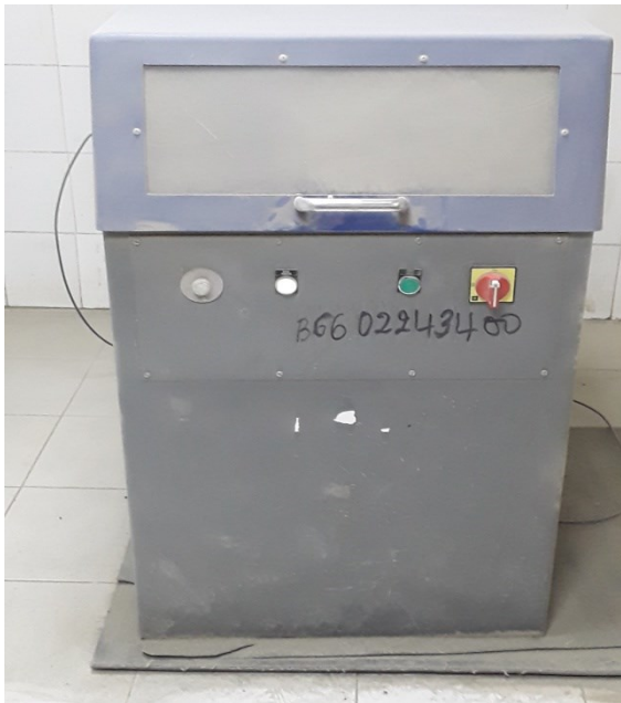
Broyage de sol
