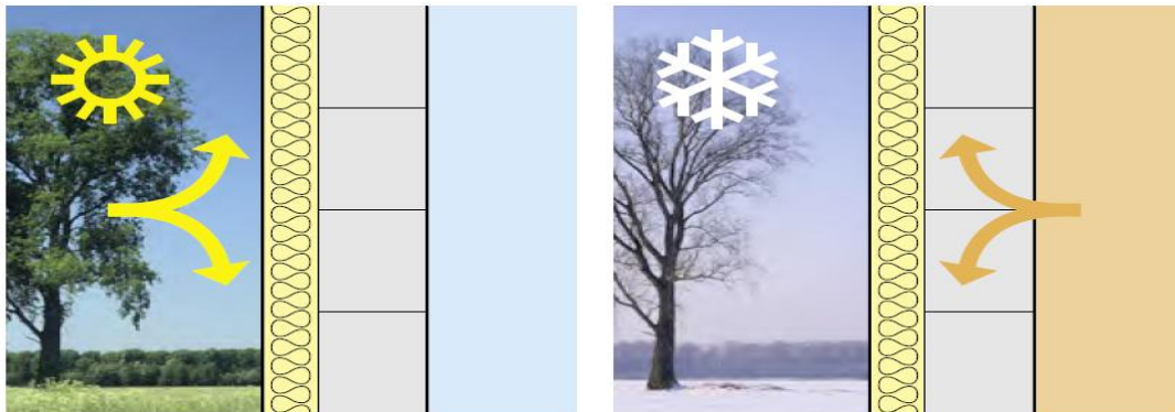
Figure 4 : Parois silico-calcaires en été : chaud dehors, frais dedans et en hiver : froid dehors, chaud dedans
