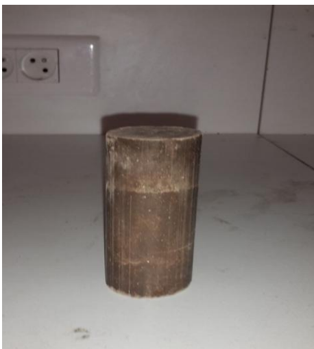
Figure 50: Eprouvettes G6 et G7 après cuisson a four
