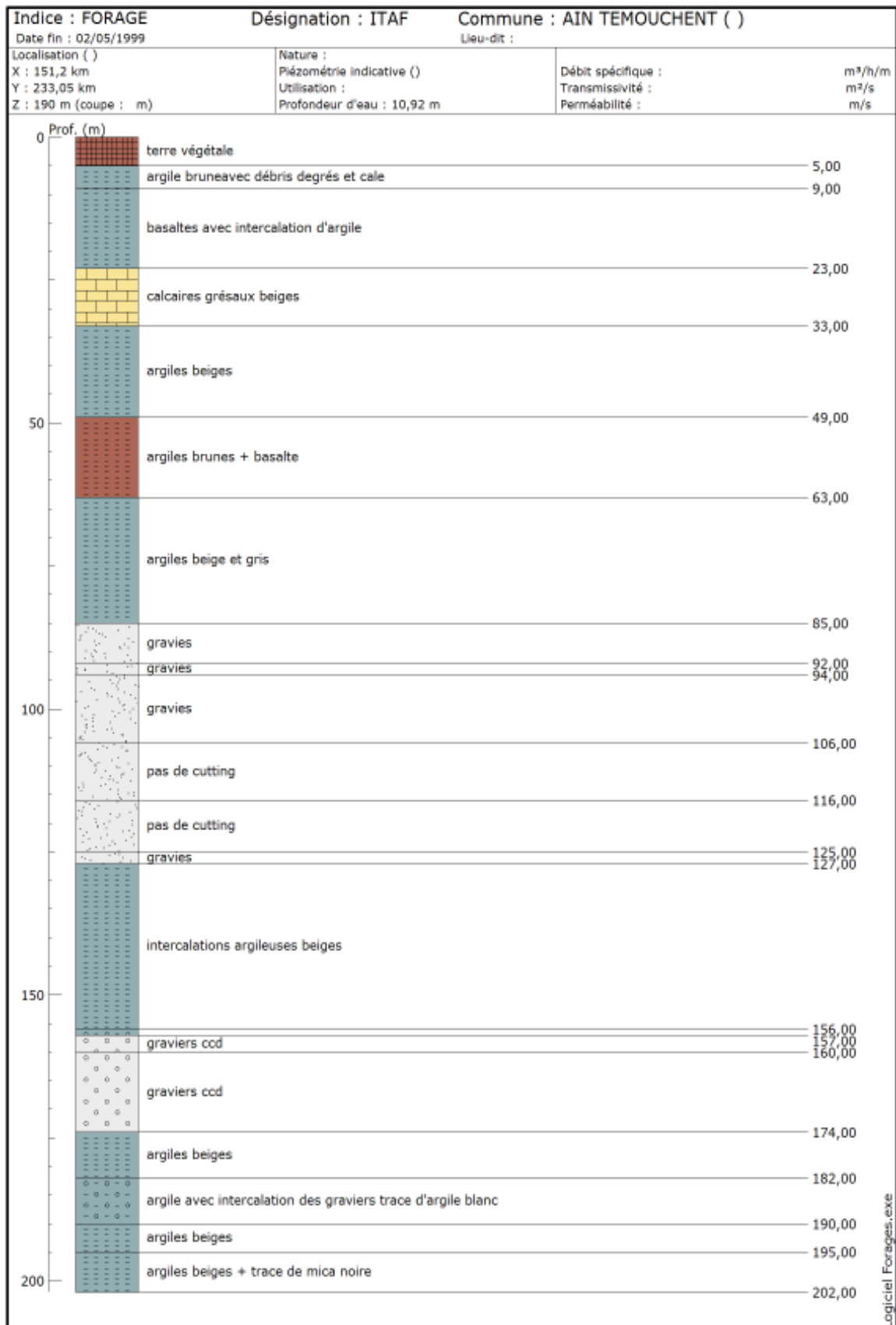
Figure I.9 : coupe géologique du forage ITAF.
