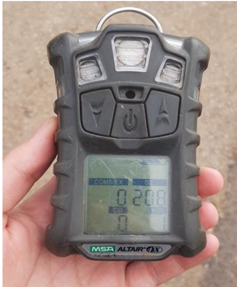
Figure III.24: Détecteur de gaz.
