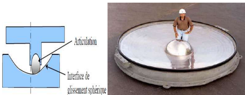
Figure 4.12. Appuis en pendules glissants FPS.
