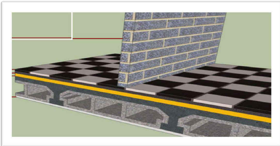
Figure 6.4. Plancher étage courant
