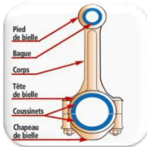
Figure 1.10 : Les composants de bielle
