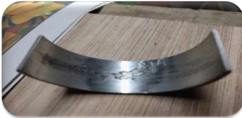
Figure 1.16 : Coussinet de bielle érodé par la cavitation
