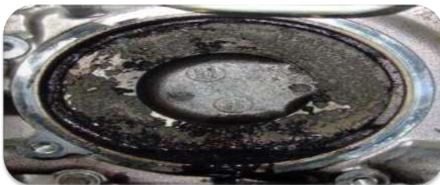
Figure 1.17 : Couvercle de pompe à eau érodé par la cavitation
