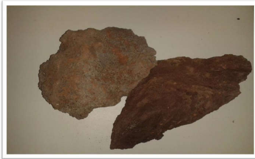
Figure II.2 : Scorie de la pouzzolane utilisée PZB de Beni-Saf
