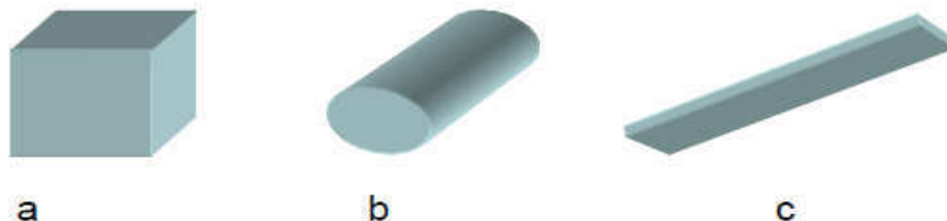
Figure I.21 : Représentation schématique des différents renforts. (a) nanoparticule ; (b) nanofibre ; (c) feuillet
