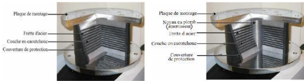
a) Appui en élastomère fretté
