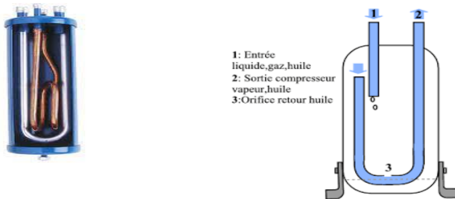
Figure II.15 : La bouteille anti-coups de liquide [58]
