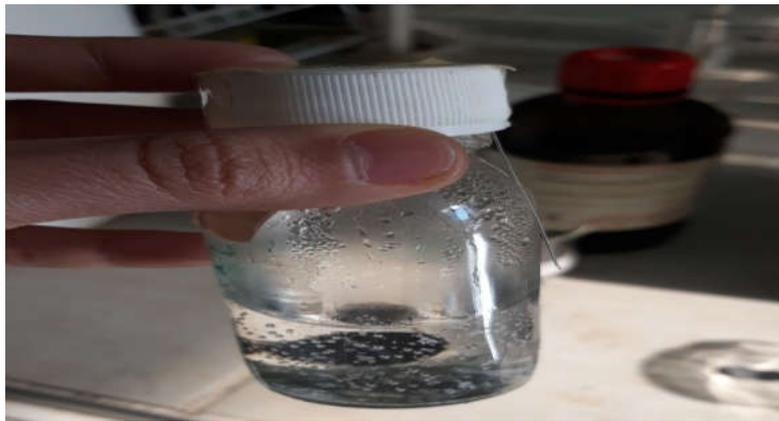
**Figure 07 :** Le dégagement de gaz et la formation de la couche noire dans la solution d'HCl 1 M à 303 K après 2 h.
