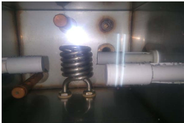
Figure 3.11 : Résistance électrique de chauffage
