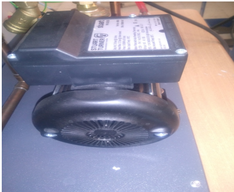
Figure 3.13 : Pompe de circulation du fluide
