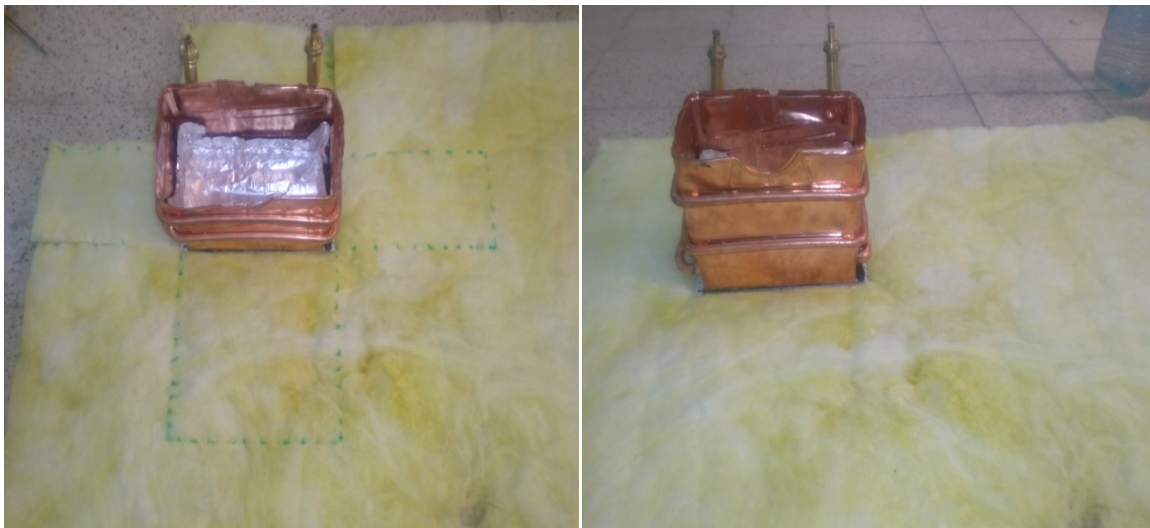
Figure 3.3 : Serpentin du chauffe-eau utilisé
