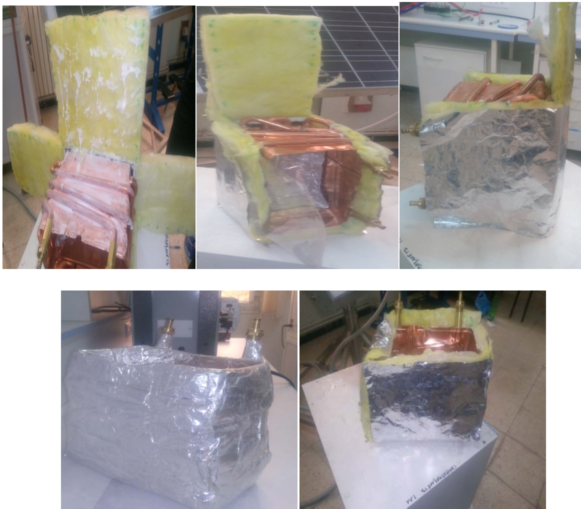
Figure 3.5 : Calorifugeage du serpentin avec la laine de verre
