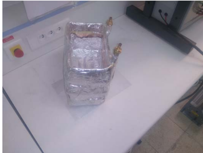
Figure 3.6 :Serpentin calorifugé avec une plaque d'aluminium à l'intérieur
