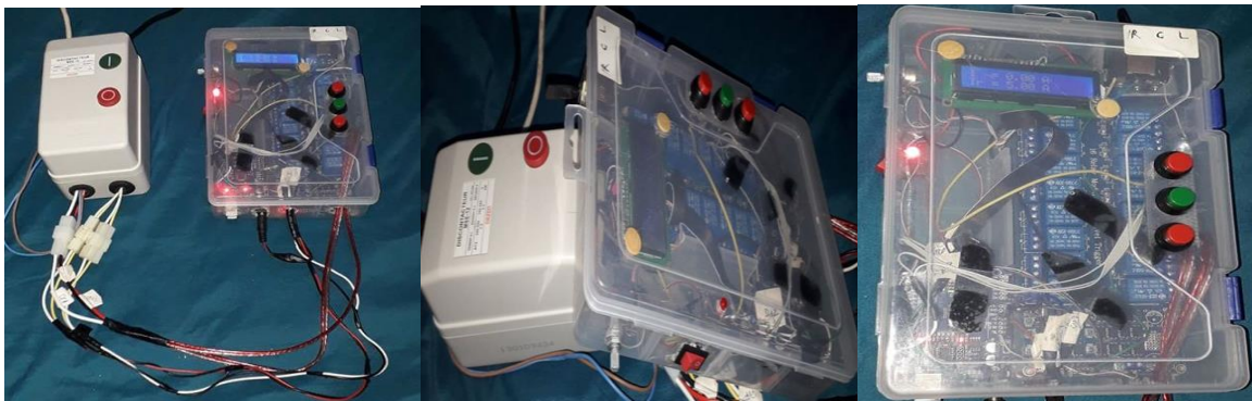
Figure IV-34 : photo de notre relais câblé avec un discontacteur. [27]
