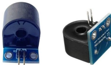
Figure IV-12: Mini Transformateur de courant ZMCT103C [27]
