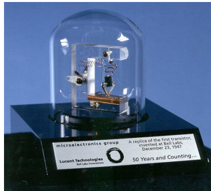
Figure I-11: photo Une réplique du premier transistor[23]
