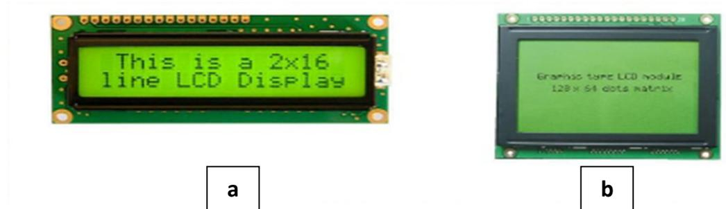
Figure II.13- (a) afficheur LCD 2\*16 caractères, (b)afficheur LCD graphique.
