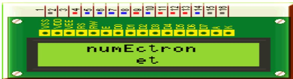
Figure II.14- Broches de l'afficheur LCD.
