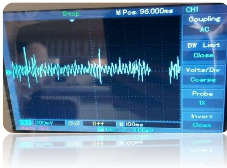
Figure III.13- signal après le filtre de Sallen Key
