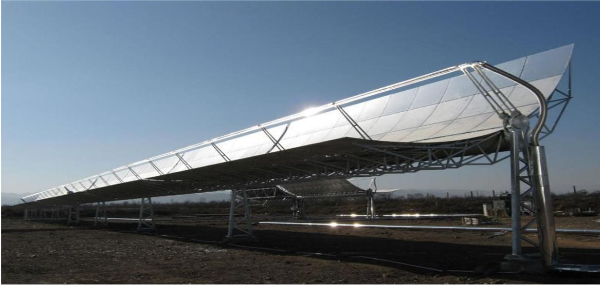
Figure I.18 : Capteur cylindro-parabolique.
