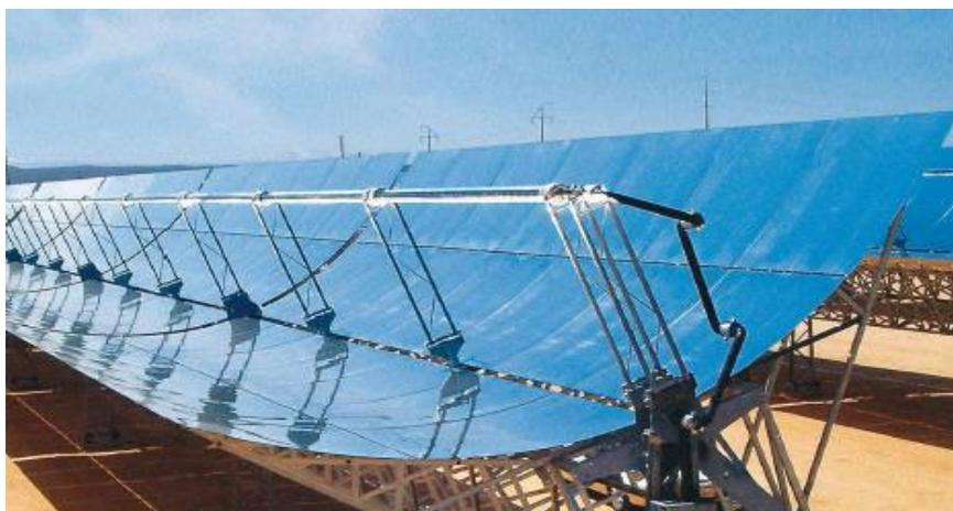
Figure 9 : Capteur cylindro-parabolique.[12]
