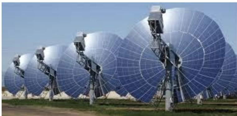
Figure 11 : Capteurs solaires paraboliques. [15]
