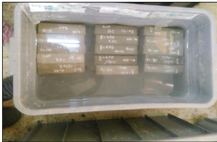
Fig. II-11. Conservation des éprouvettes dans l'eau à 20 \pm 2 °C.
