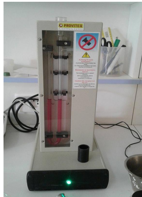
Fig. II-1. Essai de la détermination de la surface spécifique Blaine à l'aide d'un dispositif automatique (Labo. de G. Civil - CUAT).
