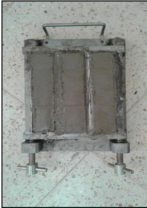
Fig. II-9. Moule d'éprouvettes Prismatiques (40x40x160) mm.
