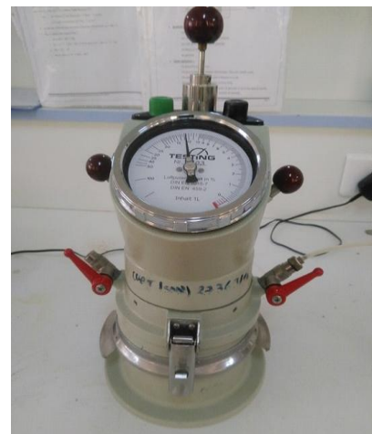
Fig. II-8. Appareil de mesure de la teneur en air occlus.
