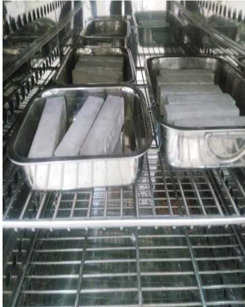
Fig. II-18. Séchage des éprouvettes de mortiers dans une étuve à 85°C.
