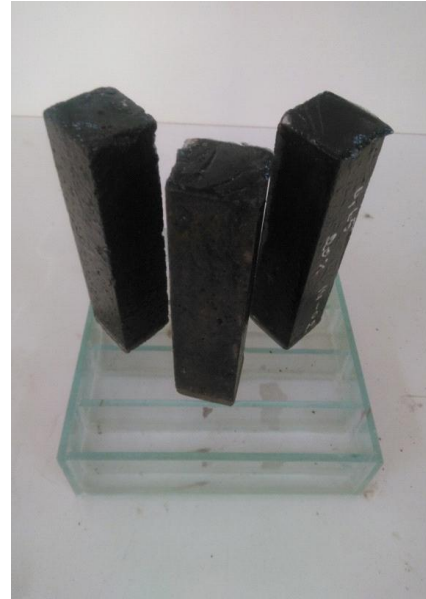
Fig. II-19. Essai d'absorption capillaire. (trois éprouvettes supportées verticalement sur un bac en verre)
