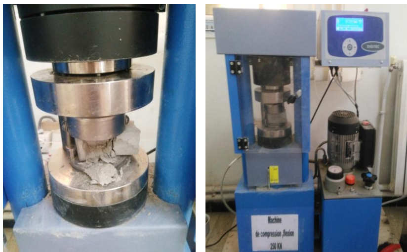
Fig. II-14. Ecrasement des éprouvettes (4x4x16) cm 3 à l'aide d'une presse hydraulique de 250kN (Laboratoire de G. Civil - CUAT).
