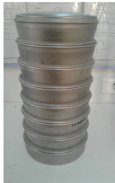
Fig. A-5. Colonne de tamis.
