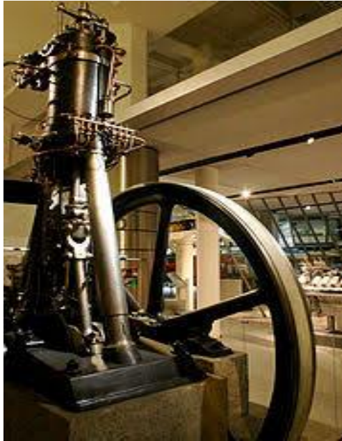
Figure 1: Le premier moteur diesel de 1897
