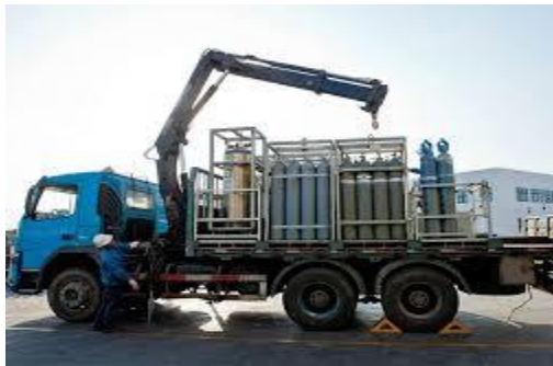
Figure 29: Les bouteilles de stockage de l'hydrogène
