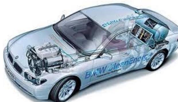
Figure 37: Une véhicule à hydrogène fonctionne avec un moteur à hydrogène thermique
