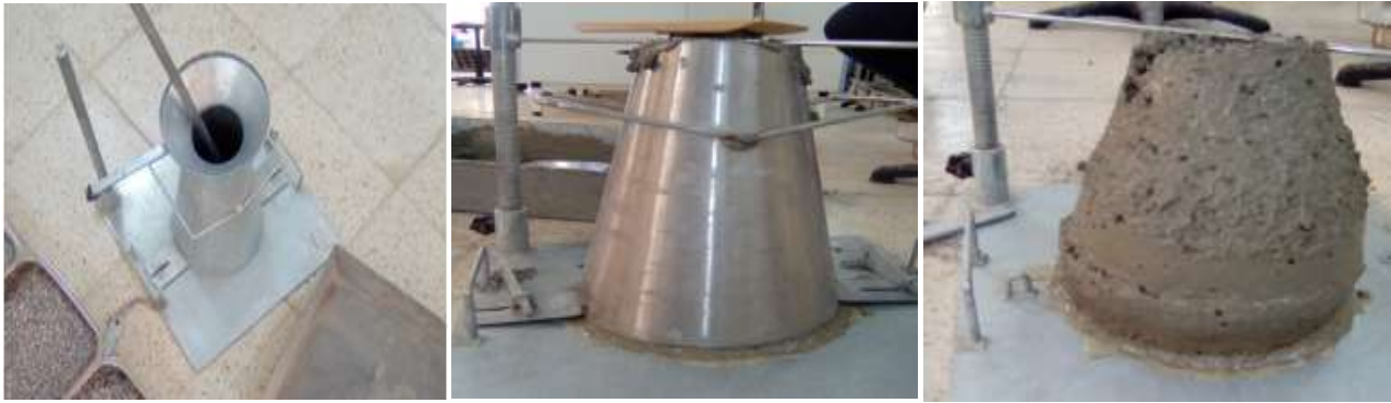
Figure 28. L'essai d'affaissement du béton frais.
