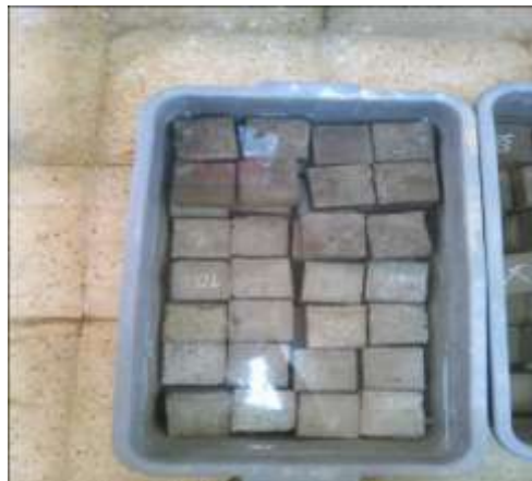
Figure 31. Conservation des éprouvettes dans un bain d'eau de 20°C.
