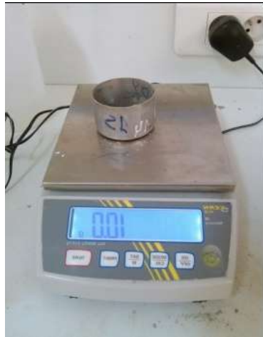
Figure 21. Essai de la masse absolue du liant.
