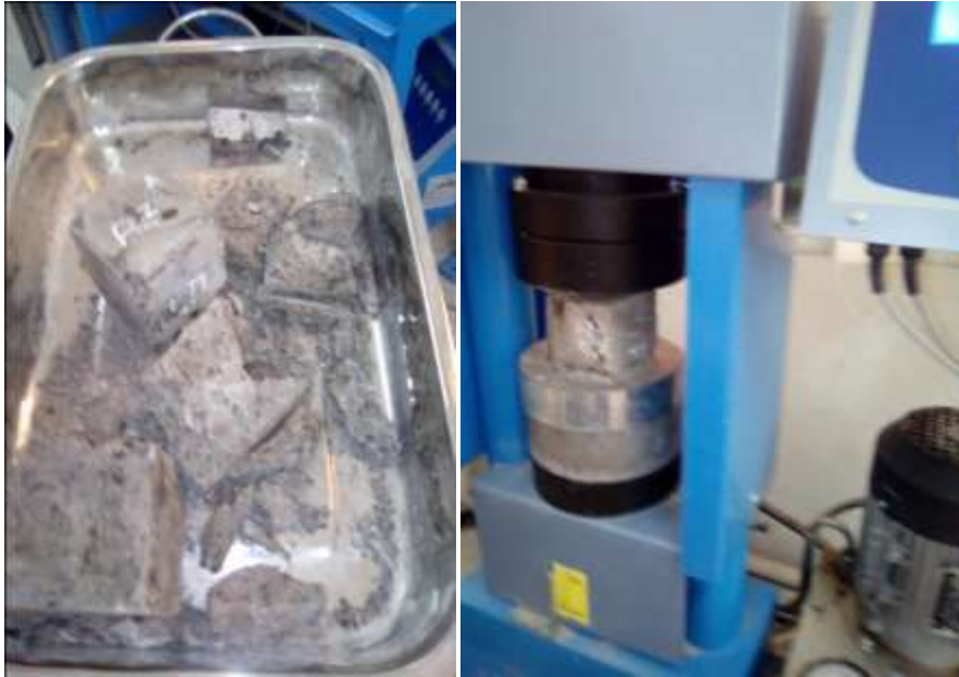
Figure 33. La rupture de l'éprouvette.
