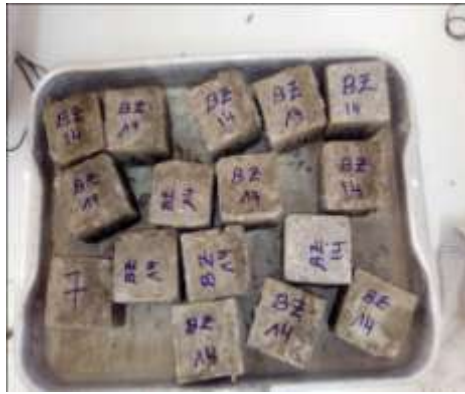
Figure 30. Le démoulage des éprouvettes.
