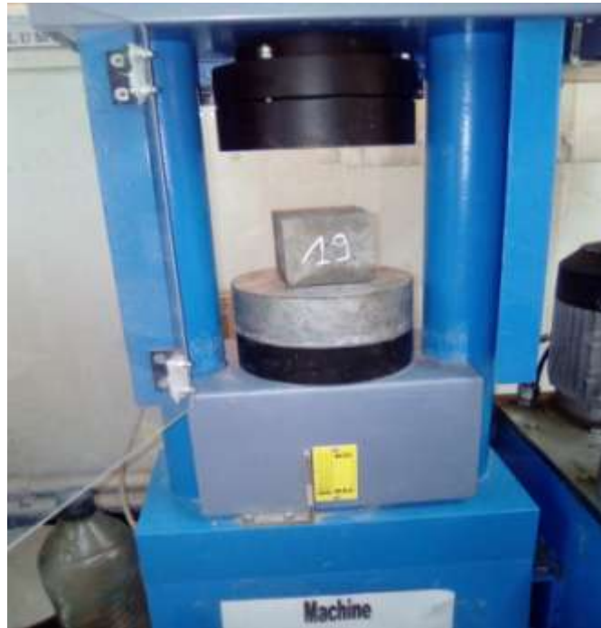
Figure 32. Machine d'essais de la compression.
