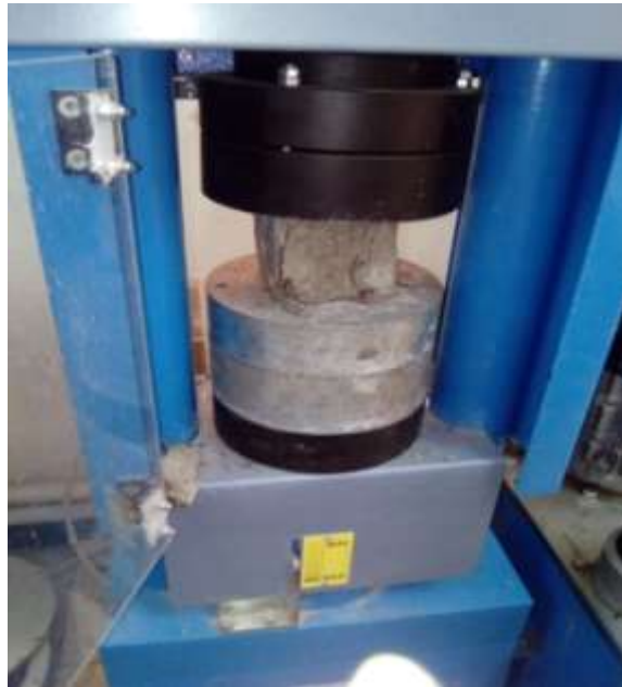
Figure 60. La rupture de béton de pouzzolane.
