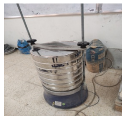
c- Tamisage du sol à 0,4 m
