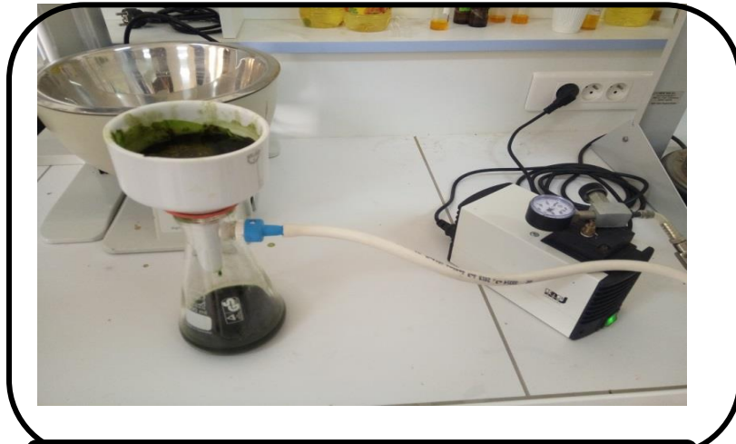
Figure 13 :Filtration sous vide
