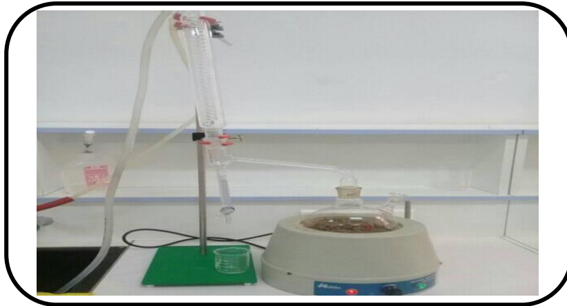
Figure 18 : Le montage utilisé pour l'extraction d'huile essentielle (d' eucalyptuscamaldulensis )
